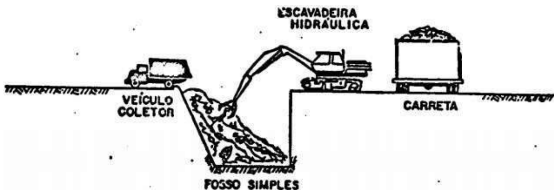
Figura 28: Esquema de modelo de Unidade de Transbordo com sistema de fosso simples e carga com escavadeira hidráulica Fonte: Consultoria Ambiental, s.d
