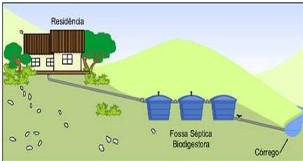
Figura 14. Modelo simplificado de tratamento de esgoto para comunidades rurais (EMBRAPA)
